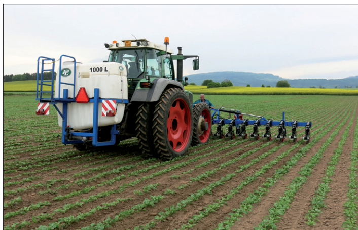
Obr. 3. Čelně nesený rám stroje a zadní nádrž na kapalné hnojivo optimálně rozloží hmotnost stroje; nádrž může být o objemu 1 000, 1 600 a 1 800 litrů
