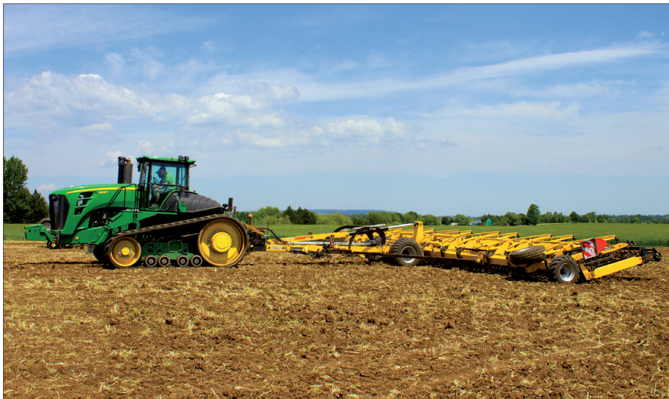
Obr. 1. Pásový John Deere s předsetovým kompaktozem Swifter SM 18000 – o rozkládání a skládání stroje se stará Bar-Lock systém
