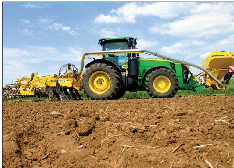
Obr. 2. Dlátový pluh Terraland TN_Profi a čelní zásobník Ferti-Box
