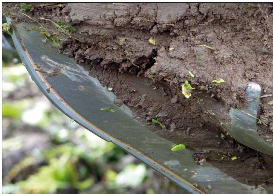
Obr. 2. Aplikace tvrdokovových destiček na vyorávací radlici
