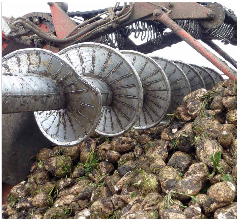
Obr. 1. Šnekový dopravník opatřený tvrdokovovým návarem
