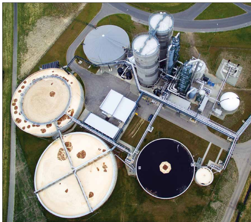
Obr. 1. Nový provoz metanizace lihovarských výpalků v areálu dobrovického závodu
