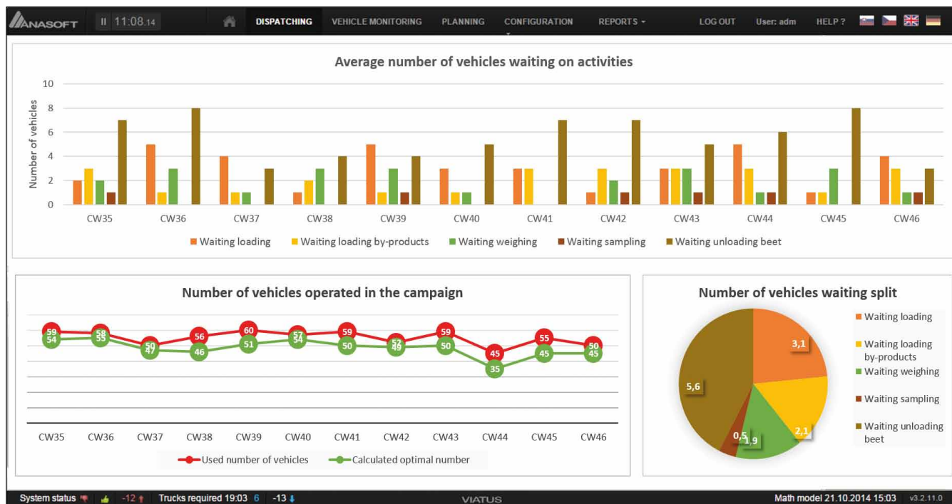
Obr. 4. Štatistické vyhodnotenie zvozu cukrovej repy – k dispozícii sú rôzne druhy prehľadov (využitie vozidiel, trvanie jednotlivých aktivít, prehľad manipulácie so skládkou a pod.)
