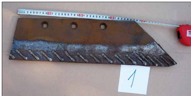
Obr. 1. Plužní čepel se šikmým návarem – varianta 1: pod úhlem 45^\circ byly provedeny návary v délce 60 mm a rozteči cca 40 mm
