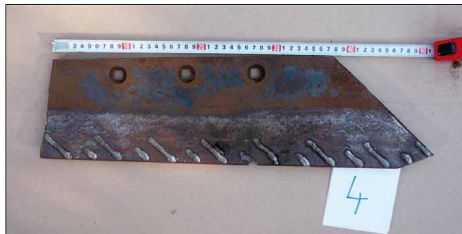
Obr. 4. Plužní čepel se šikmým návarem – varianta 4: pod úhlem 45^\circ byly provedeny návary v délce 30 a 60 mm a rozteči cca 40 mm
