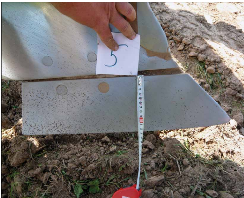
Obr. 6. Opotřebení plužní čepele (etalon) po orbě 12 ha
