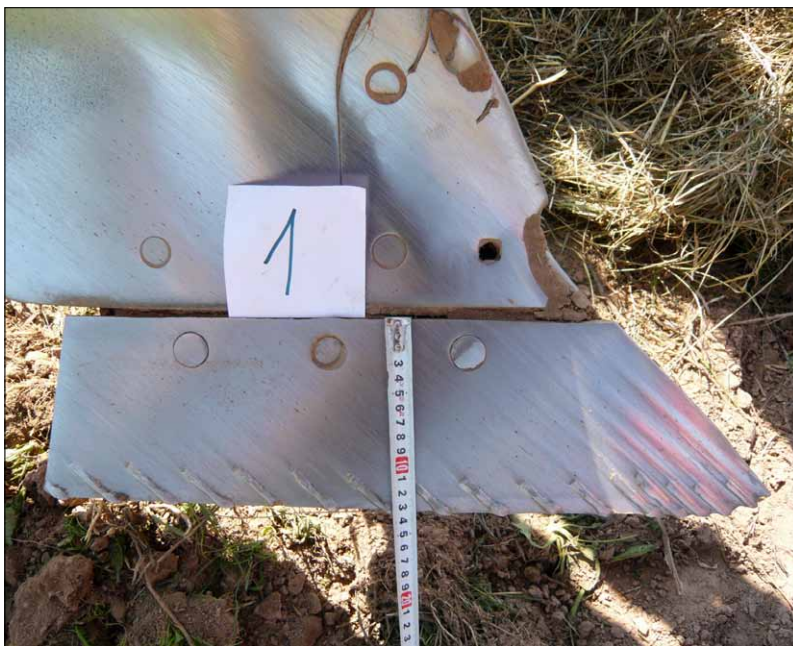
Obr. 7. Opotřebení plužní čepele (varianta 1) po orbě 12 ha
