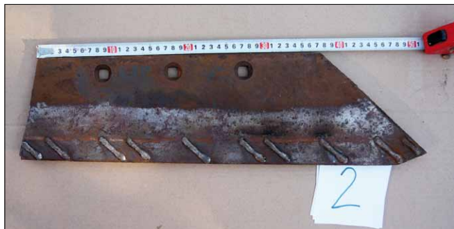
Obr. 2. Plužní čepel se šikmým návarem – varianta 2: pod úhlem 45^\circ byly provedeny návary v délce 60 mm a rozteči cca 40 a 80 mm
