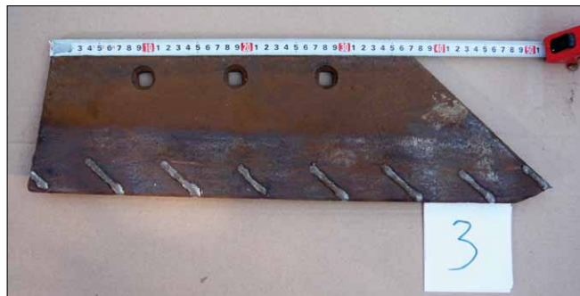
Obr. 3. Plužní čepel se šikmým návarem – varianta 3: pod úhlem 45^\circ byly provedeny návary v délce 60 mm a rozteči cca 80 mm
