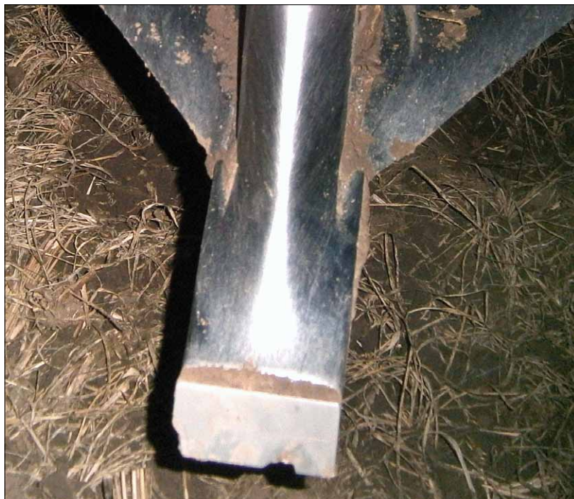
Obr. 2. Počátek fragmentace břitové destičky ze slinutých karbidů
