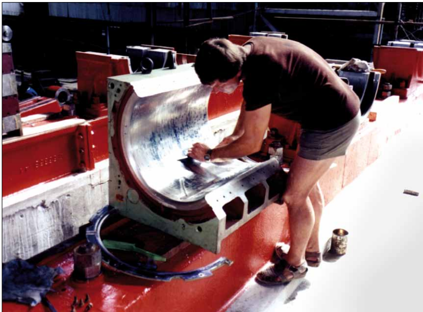
Obr. 4. Výstelka ložiska ložiskovým kovem, ojediněle prováděla právě Škoda Plzeň; taková ložiska lze snadno opravit nebo znovu vylít – na obrázku zaškrabávání ložiska (náročnější montáž, která se vyplátí)
