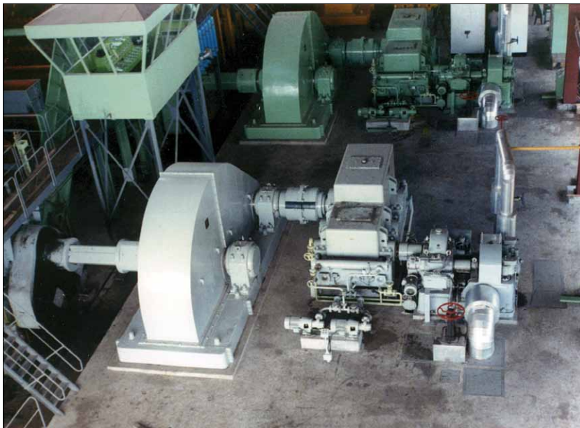
Obr. 8. Mlýnská turbína 950 kW s kompletními převody instalovaná ve filipínském cukrovaru Don Pedro (foto 1989)
