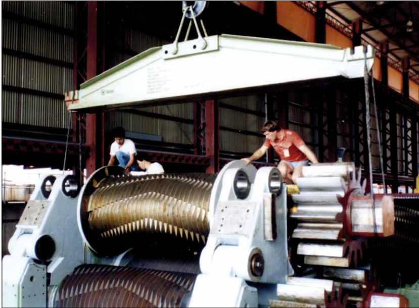
Obr. 3. Montáž horního mlýnského válce s drážkováním „Fulton“ (1989)
