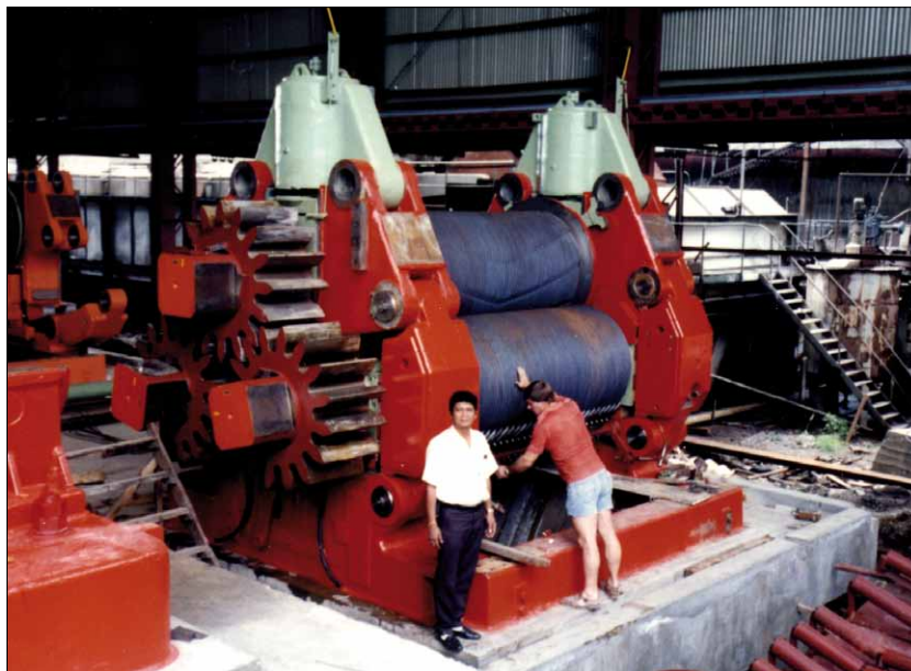
Obr. 6. Mlýn cukrovaru Don Pedro na Filipínách – výkon 8 tis. t.d -1 třtiny, provedení pětiválcová stolice, rozměry 42,5 × 86 palců (od té doby standard) (1989)
