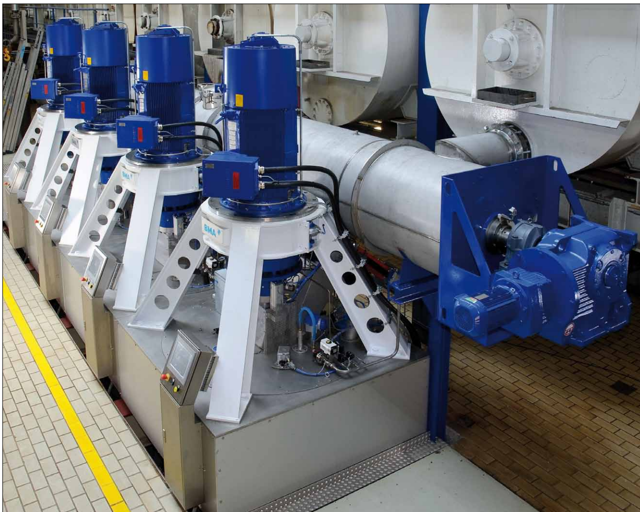
Obr. 4. Stanice odstředivek v cukrovaru Plattling vybavená čtyřmi odstředivkami E1810 a rozdělovacím mísidlem BMA
