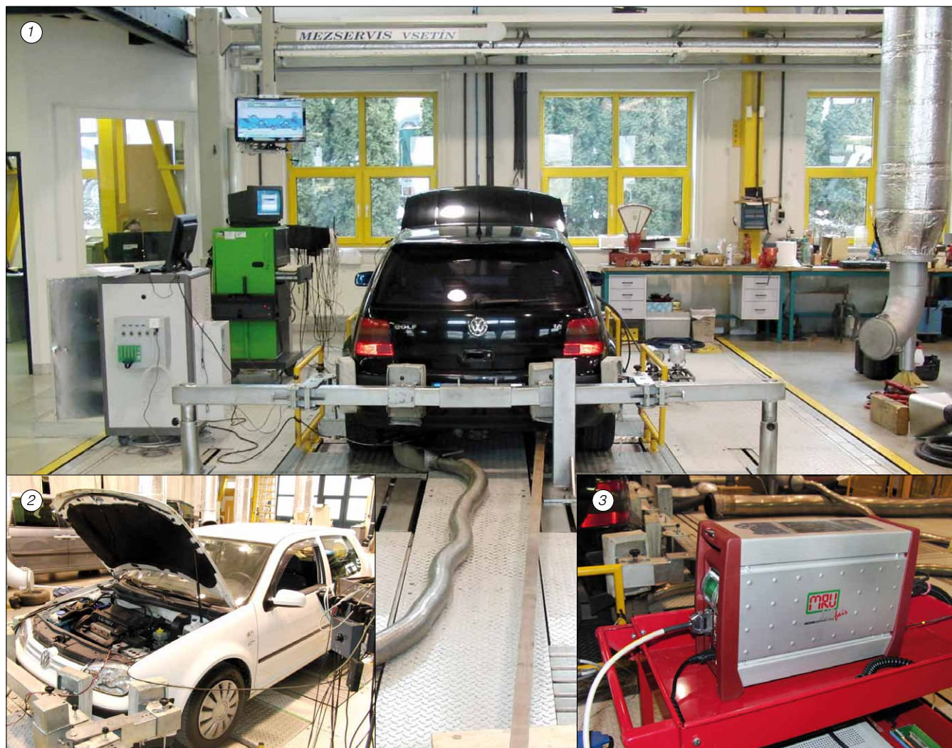
Obr. 1. Zkoušená vozidla ve vozidlových laboratořích Ústavů techniky a automobilové dopravy: 1 – vozidlo Volkswagen Golf 1.6 na válcovém dynamometru; 2 – vozidlo Volkswagen Golf 1.4; 3 – přenosný emisní analyzátor spalín MRU Vario Plus
