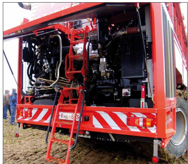
Obr. 7. Motorová část se šestiválcem Mercedes Benz
