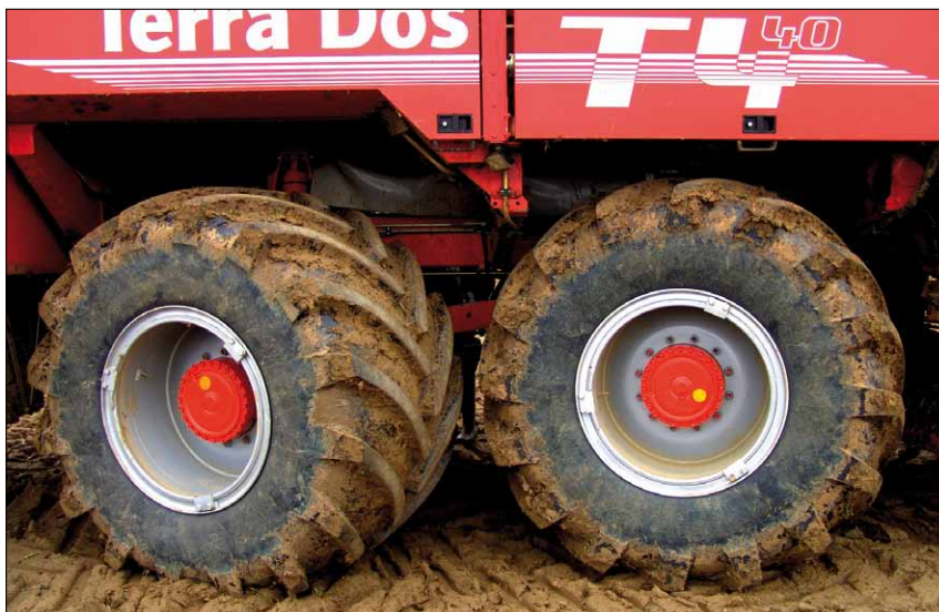
Obr. 4. Široké pneumatiky 1050/50 R32 na střední a zadní nápravě sklízeče
