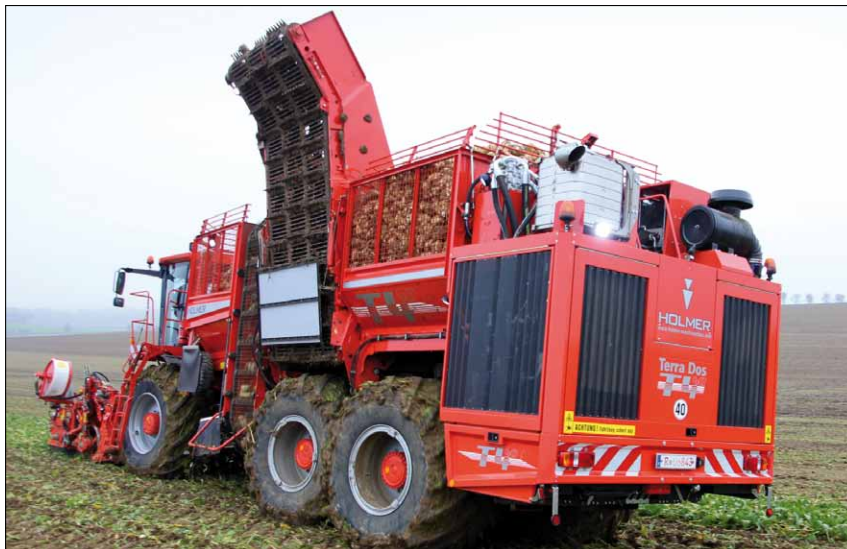
Obr. 2. Terra Dos T4-40 disponuje zásobníkem na více než 30 t sklizených bulev
