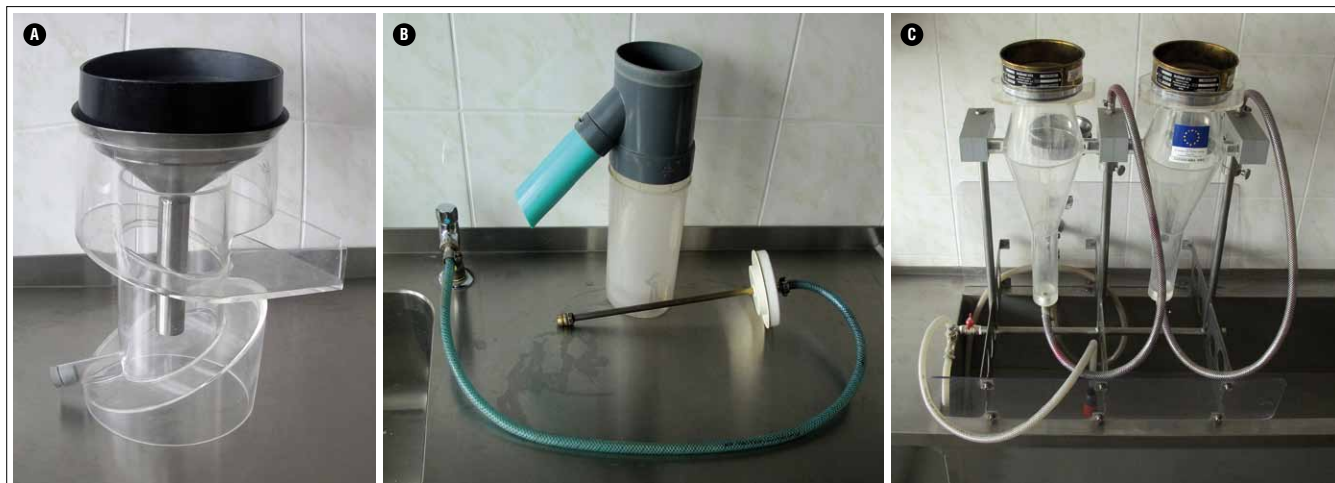
Obr. 6: Plavící zařízení pro extrakci cyst z půdního vzorku (A – Fenwickova konvice, B – modifikovaná, vlastnoručně vyráběná plavící konvice, C – Thomasova konvice)
