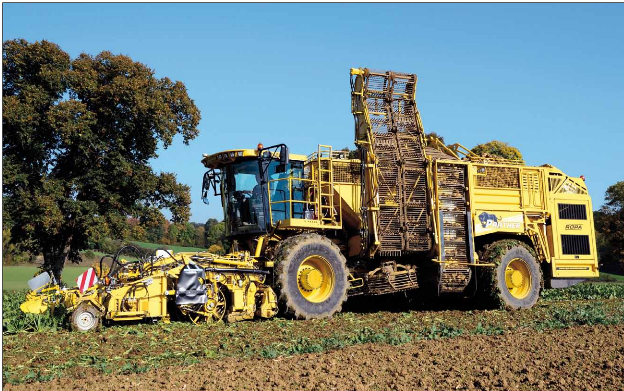
Obr. 4. Sklízeč euro-Panther využívá zařízení Micro-Topper pro maximální výnos sklizené řepy
