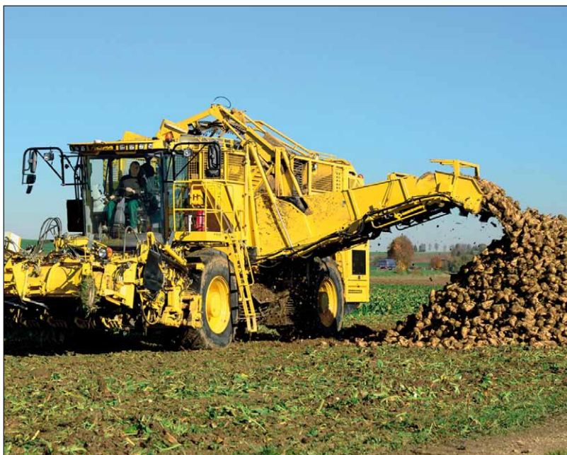
Obr. 5. Široký výložníkový pás umožňuje rychlé vyprázdnění stroje
