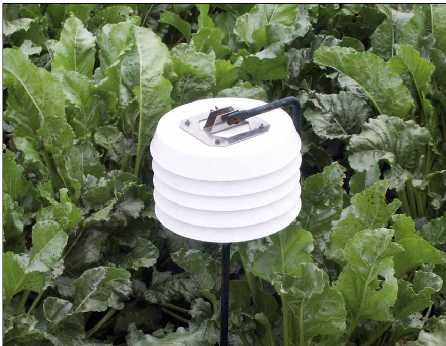
Obr. 4. Meteostanice v porostu cukrovky pro sledování teploty a vlhkosti
