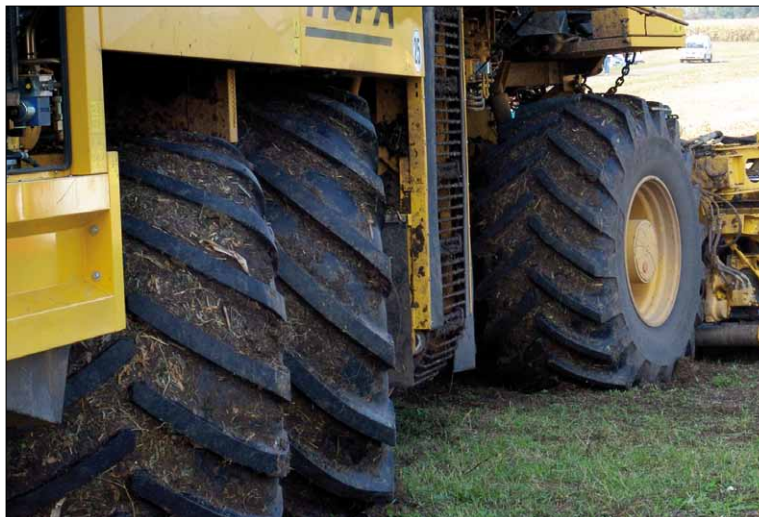
Obr. 2. Tři nápravy stroje ROPA euro-Tiger minimalizují utužení půdy
