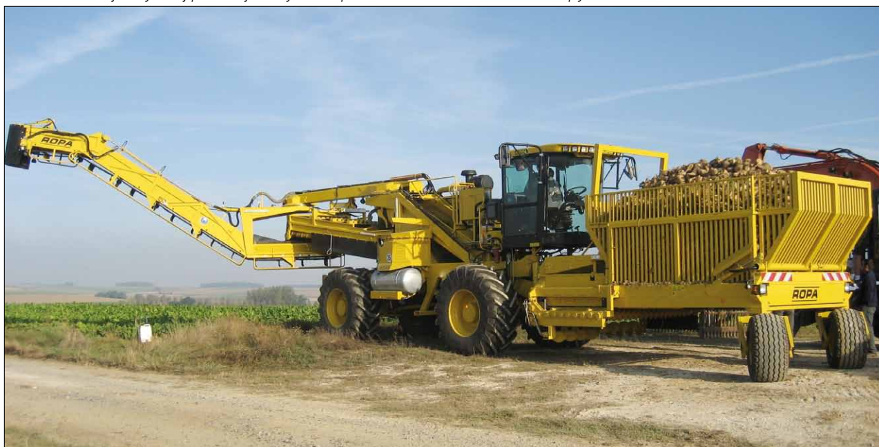
Obr. 11. Samojízdný stroj pro dvojfázový koncept čištění a nakládání cukrové řepy ROPA Euro-BunkerMaus 3
