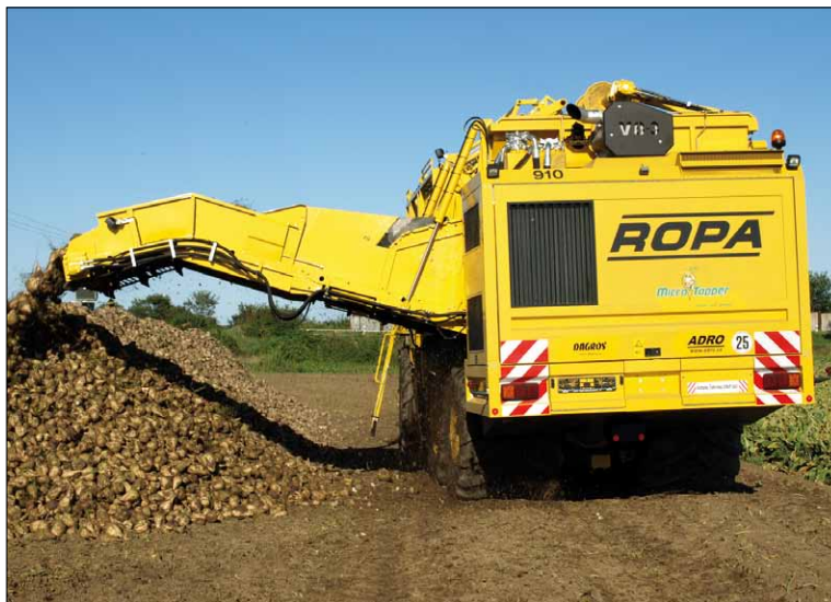
Obr. 4. Široký vyprazdňovací dopravník umožňuje rychlé vyložení zásobníku
