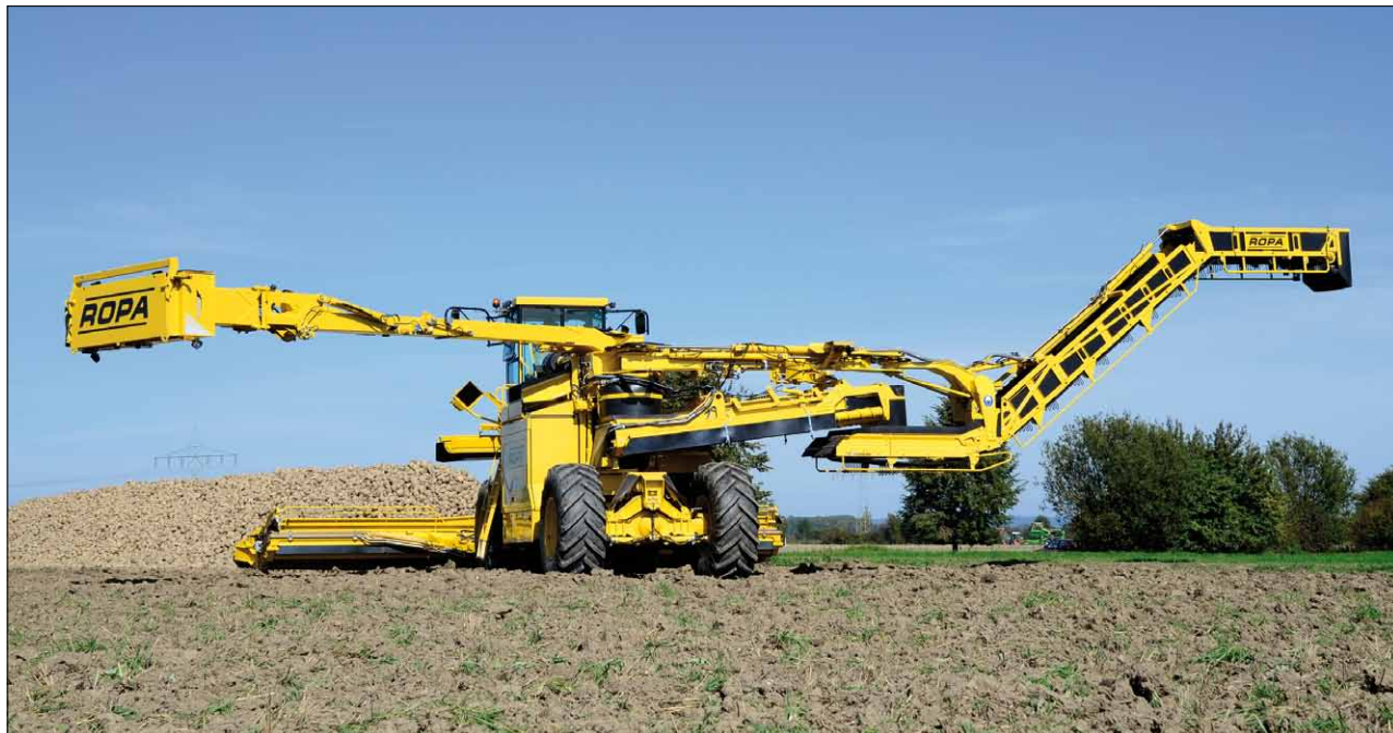
Obr. 8. Nový typ samochodného čistícího nakladače euro-Maus 4 patří k největším a nejvýkonnějším na světě
