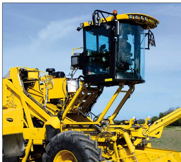
Obr. 10. Výškově nastavitelná kabina euro-Maus 4
