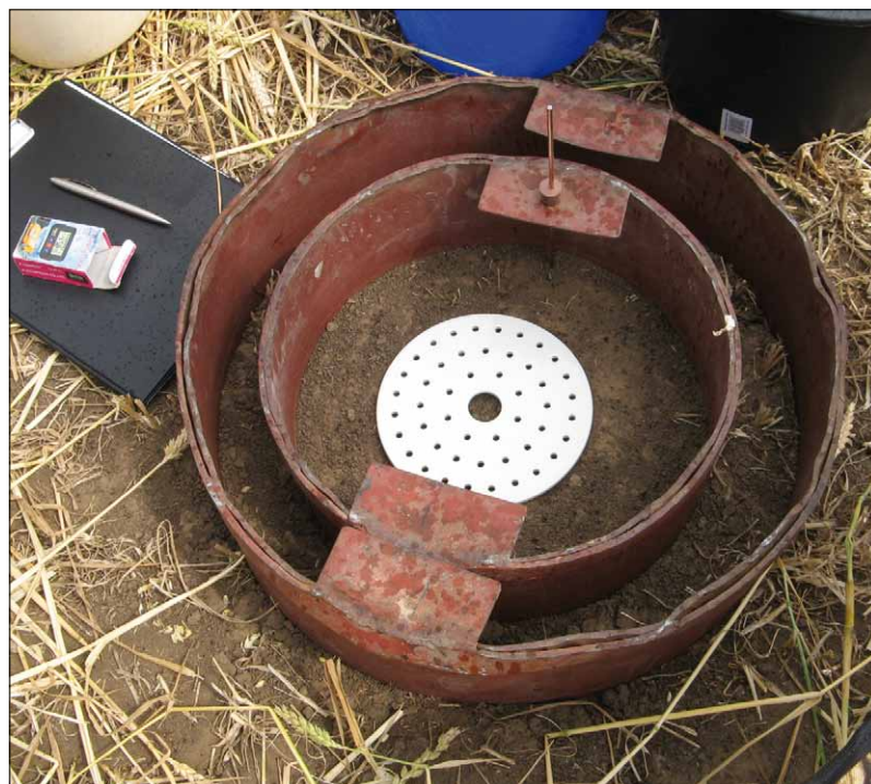
Obr. 3. Detailní pohled na infiltrační válec
