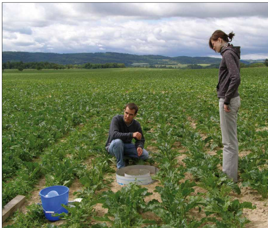
Obr. 2. Měření infiltrace pomocí soustředných válců
