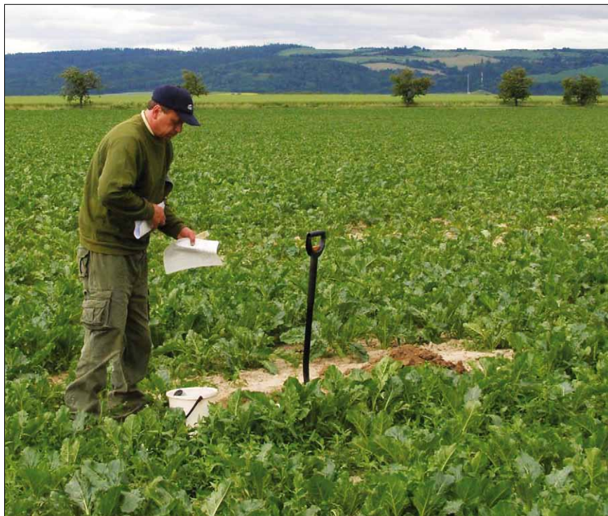
Obr. 1. Příprava kopané sondy pro odběr půdních vzorků
