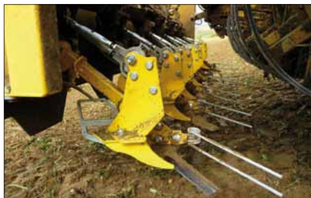
Obr. 2. Micro-Topper 2 s novou automatikou seřezu
