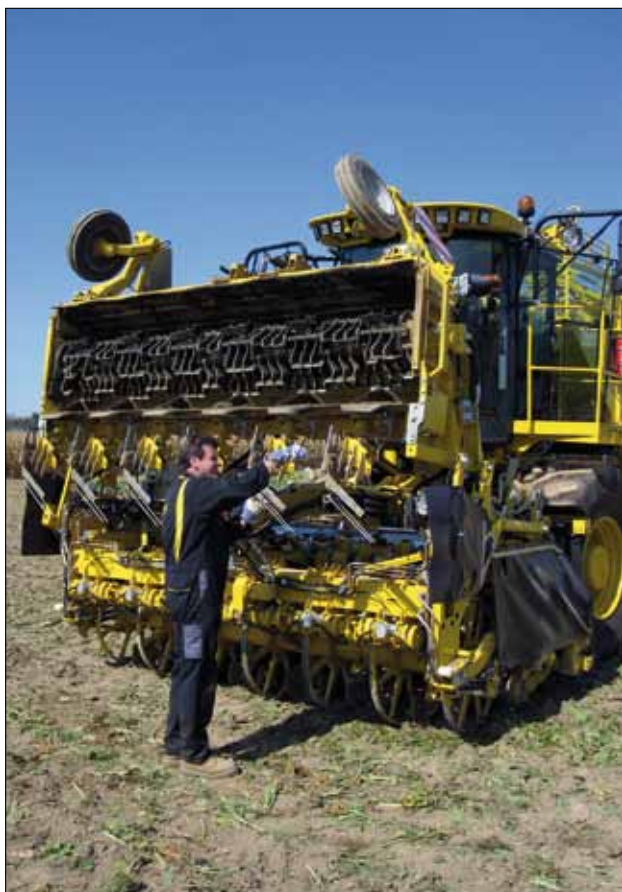
Obr. 1. ROPA Micro-Topper 2 na euro-Tigeru V8-3 – kontrola nožů v pohodlné údržbové poloze cepového ořezávače
