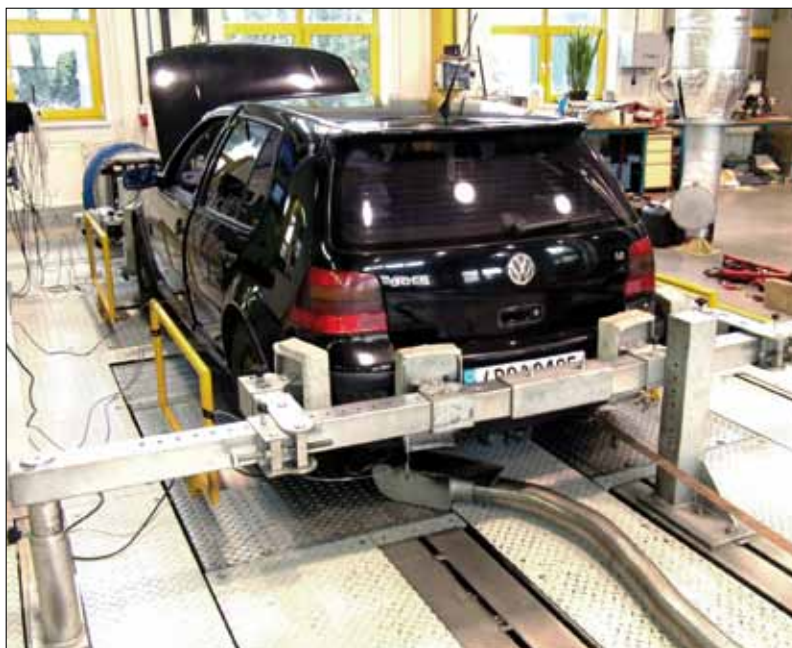
Obr. 1. Vozidlo spalující E85 na válcovém dynamometru
