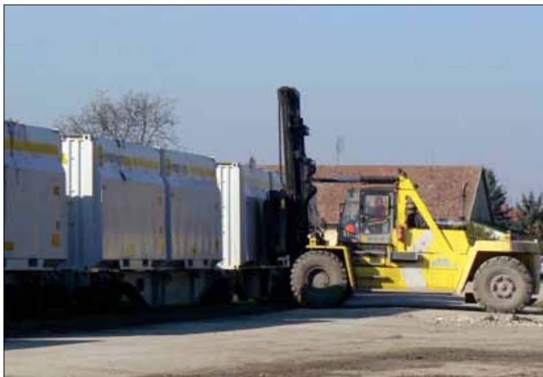
Obr. 3. Vykládka kontejnerů vysokozdvizným vozíkem Kalmar DCF 370-12
