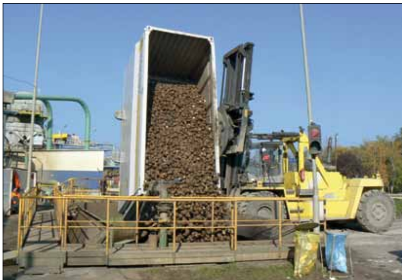
Obr. 4. Vysypání cukrovky z kontejneru do splavu cukrovaru v Seredi
