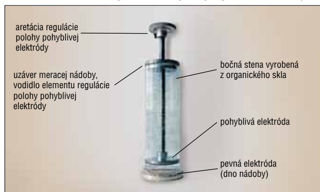
Obr. 1. Merací prístroj, v ktorom boli mikroorganizmy podrobené účinku bleskových elektrických výbojov elektrického poľa
