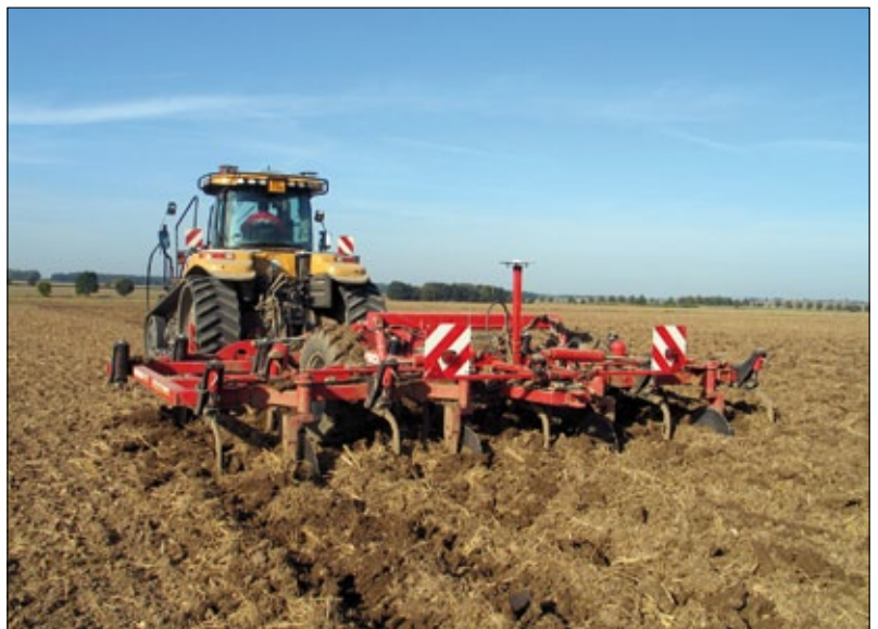
Obr. 1. Traktor Challenger s dlátovým kypřičem HORSCH doplněný hrůbkovacími radličkami na každém druhém tělese (při pracovním záběru 6 m vytváří kypřič 8 hrůbků s roztečí 0,75 m; traktor i kypřič jsou automaticky řízeny podle GPS RTK – systém Autofarm)
