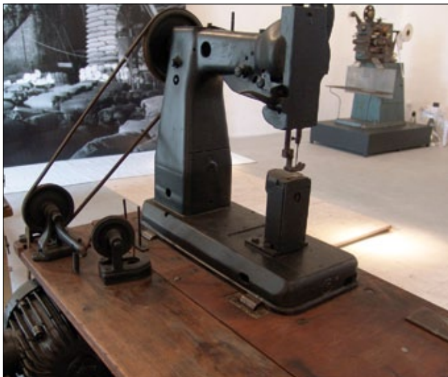
Obr. 15. Stroj na šití pytlů, v pozadí balicí stroj RA 4
