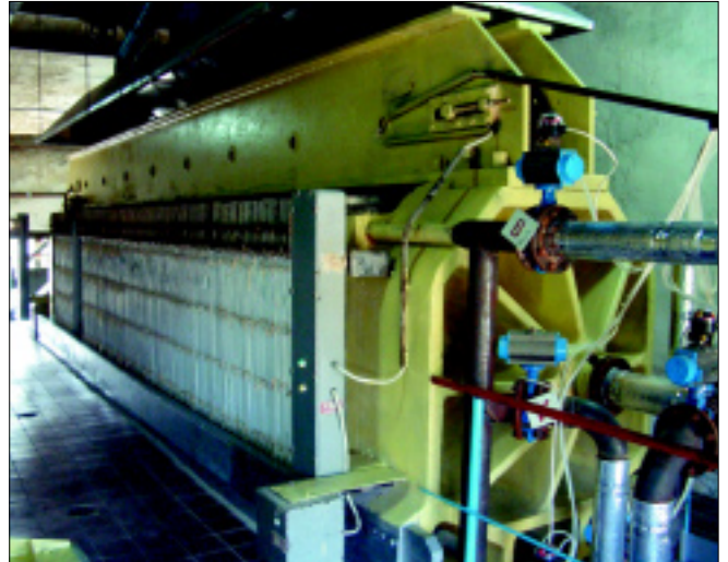
Obr. 6. Zariadenie na filtráciu zahusteného podielu 1. satur. šťavy
