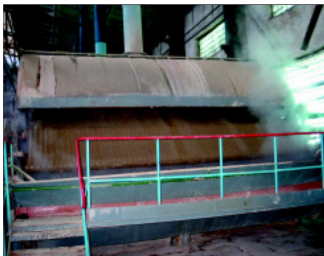
Obr. 2. Zariadenie na filtráciu zahusteného podielu prvej saturovanej šťavy do roku 2006
